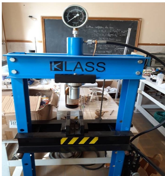
Fig. 4.5 Presă hidraulică pentru încercări
