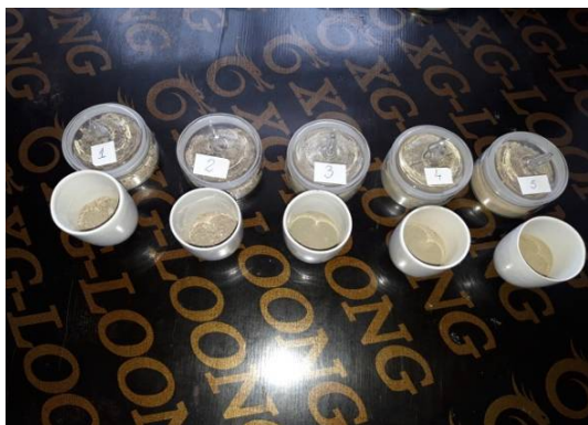
Fig 3.6 Pregătirea probelor pentru calcinare
