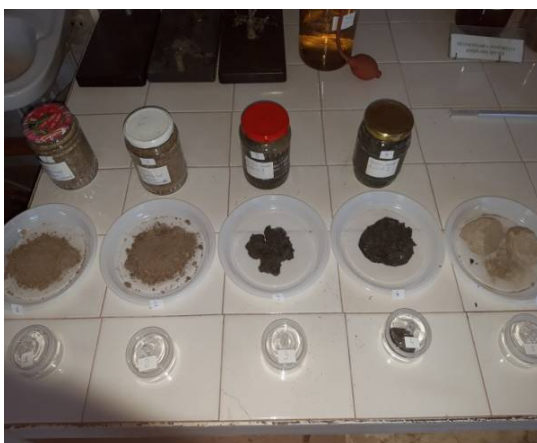
Fig. 3.1 Pregătirea probelor pentru determinarea umidității;
