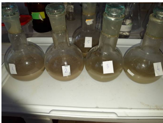
Fig. 3.4 Pregătirea probelor pentru CTSS Determinarea sărurilor;
