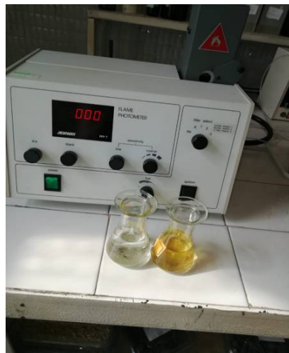
Fig. 3.11 Determinarea capacității totale de schimb cationic
