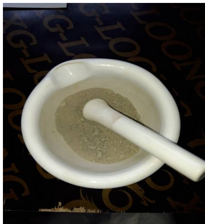
Fig. 3.9 Pregătirea probelor pentru cernere
