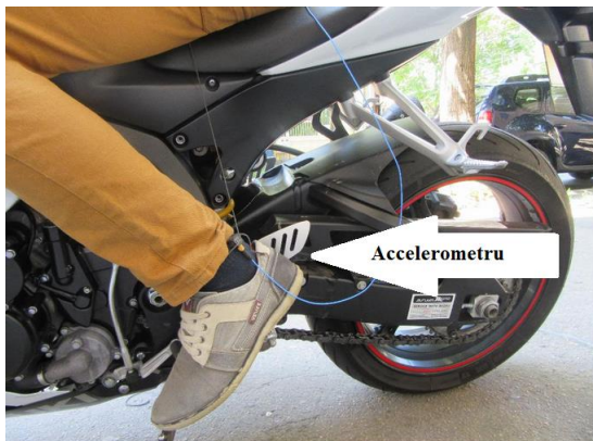
Figura 2. Accelerometrul montat la picior
